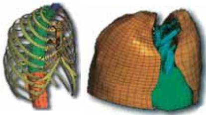
Figure 1. Exemple de représentation d'un thorax humain par éléments finis (ESI Group).
