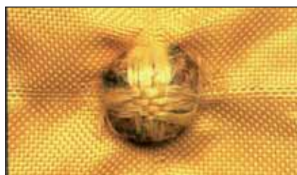
Photo 5. Arrêt d'un projectile de 9 mm par un tissu de fibres d'aramides.
